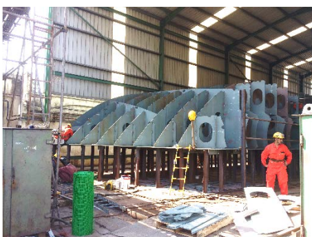
切断及び加工した鋼板を溶接作業により ブロックを製作
